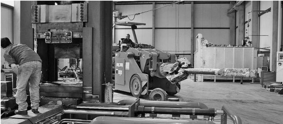
Aus einem Ausgangsquerschnitt von 300 mm vierkant wurden die Kolbenstangen auf einen Durchmesser von 185 mm rund einseitig vorgeschmiedet. Im Anschluss wurde auf der anderen Seite das Kolbenstangenauge mit einem Maß von 450 mm Breite, 150 mm Dicke und 500 mm Länge angeschmiedet.
