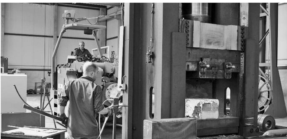
Letzter Arbeitgang ist das Lochen des Auges, bei dem ein Loch von 150 mm Durchmesser mit einem speziellen Dorn eingepresst wird. Der Arbeitsaufwand pro Kolbenstange, die eine Gesamtlänge von mehr als 3,5 Metern haben, betrug eine Stunde.
