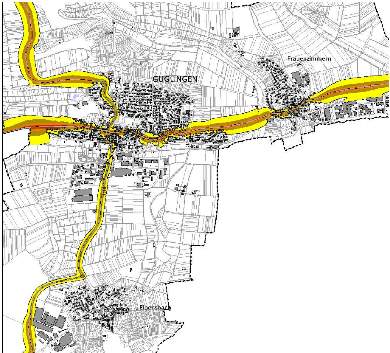
Abbildung 2: Straßenverkehr – Lärmbelastung, Berechnung nach VBUS LNight
